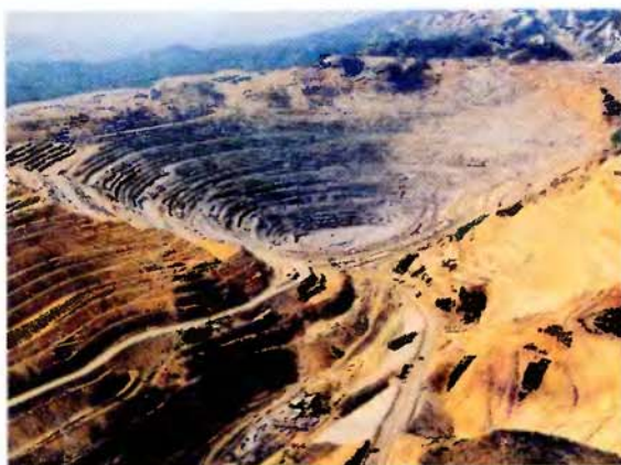
Рис. 123. Глубина карьера в США, где добывают медную руду, достигает 740 м
